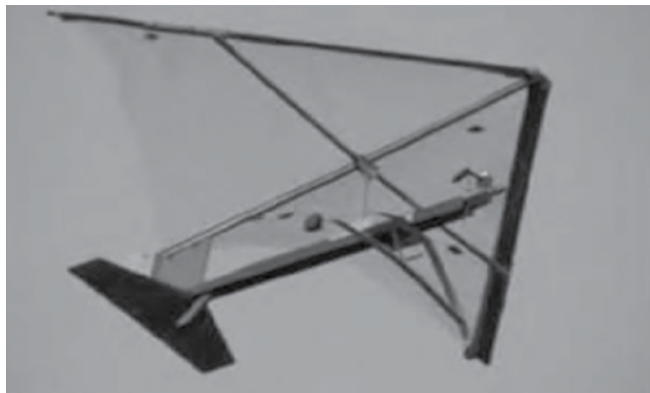
Рис. 45. БпЛА з гнучким крилом
