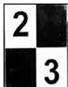
Рис. 14. Марка для позначення ситуаційних точок
