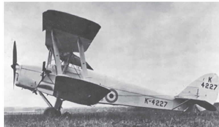
Рис. 37. Перший радіокерований БпЛА – Н.82В Queen Bee
