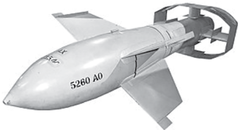
Рис. 40. Радіокерована бомба «Fritz X»
