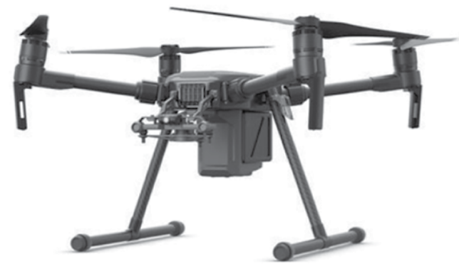
Рис. 22. Мультикоптер DJI Matrice 200 V2 Combo
