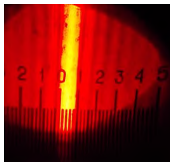
Рисунок №2 – Зображення явища дифракції у процесі використання синього та червоного світлодіодів
