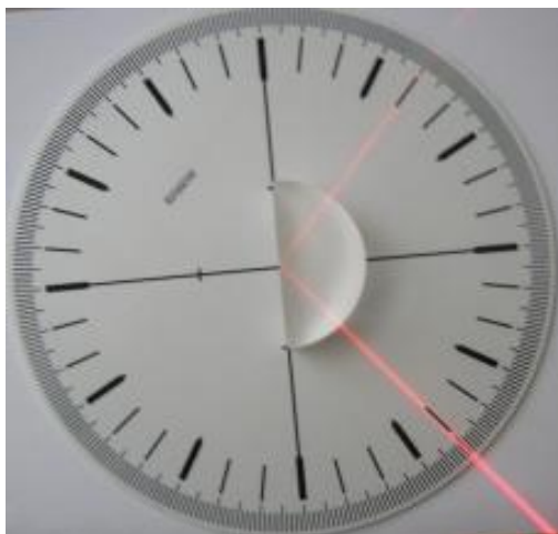
Рис. 3.22 Зображення рівності кутів падіння та відбивання
