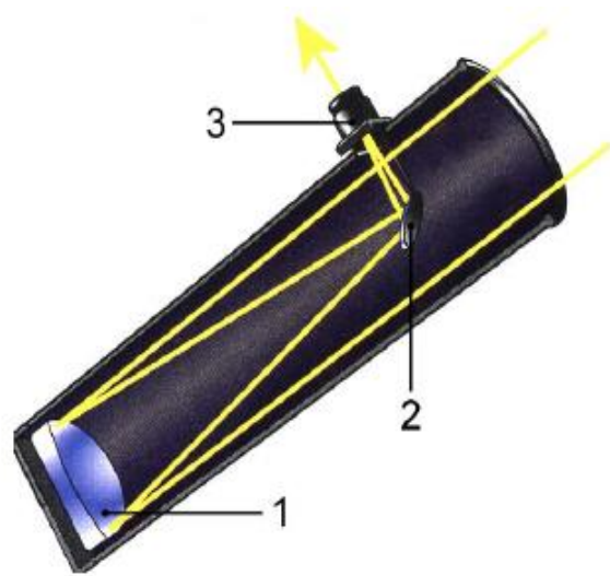
б – схема телескопа-рефлектора
