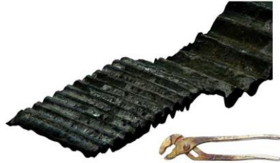
Рис. 24. 3D-модель робочої поверхні кліщів, отримана за допомогою системи ToolScan (зображення з сайту виробника)
