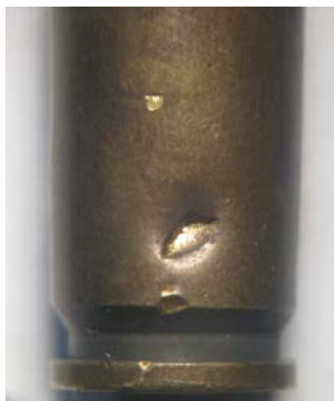
Рис.4. Сліди на бічній поверхні гільзи, стріляної з пістолета ПМ, оснащеного глушником
