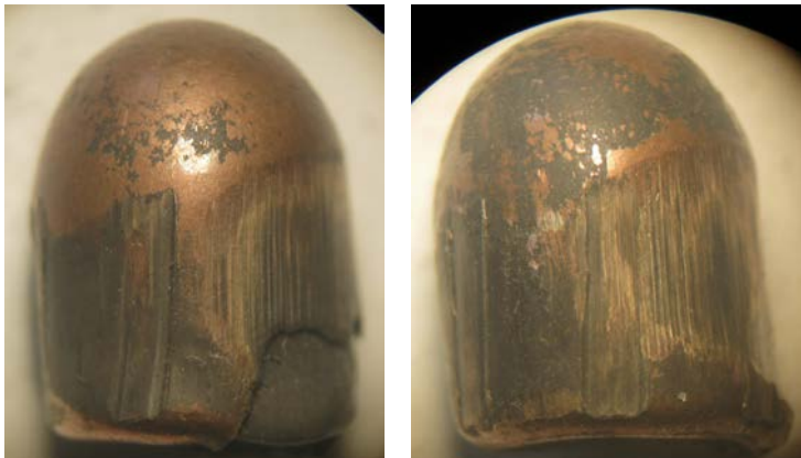
Рис.1. Сліди глушника на кулях, стріляних з 9-мм пістолета-кулемета «Вовк»
