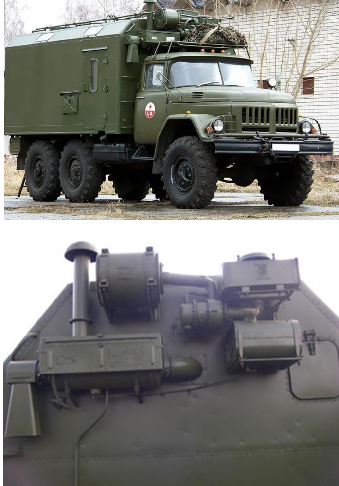
Рис.2 – ФВУА-100 встановлена на Р-136 «Зубр» - КВ радіостанції великої потужності [2, 4].
