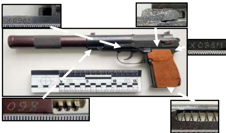
Ілюстрація № 2. Маркувальні позначення на деталях пістолету ПБ.
