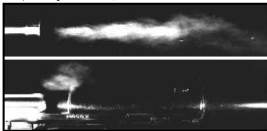
Ілюстрація № 9. Вихід порохових газів та крапель олії з ПЗРЗП ПБ (верхній знімок) та казенної частини ствола зброї (нижній знімок).
