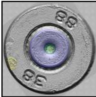
Ілюстрація № 3. Зображення слідів на гільзі, стріляної з пістолета ПБ.
