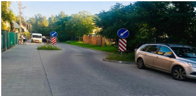
Рис. 1.41. Застосування шиканів згідно з ДСТУ 4092-2002 [4].
