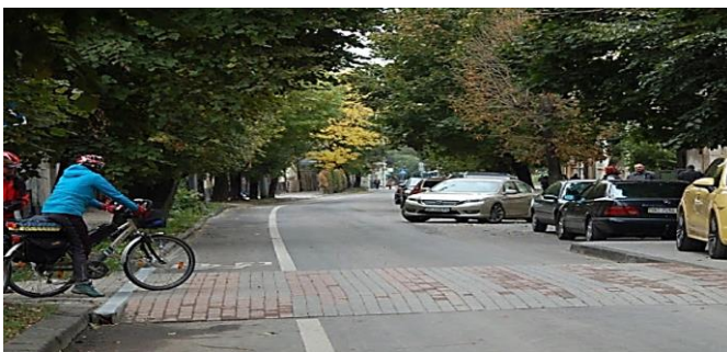
Рис. 1.43. Застосування підвищення пішохідних переходів згідно з ДСТУ 4092-2002 [4].
