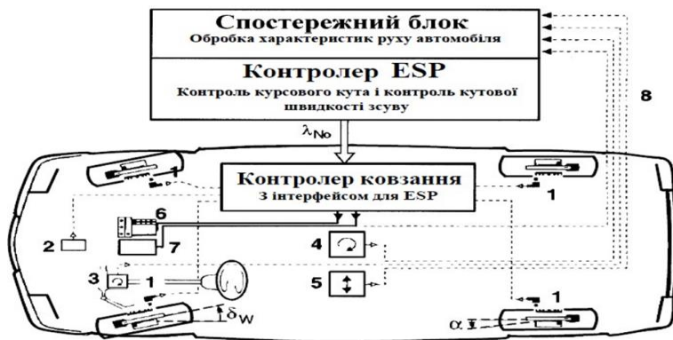
Рис. 2.2 Електронна система керування гальмами ESP: 1 – датчик швидкості обертів коліс; 2 – датчик тиску в гальмовій системі; 3 – датчик положення рульового колеса; 4 – датчик кутової швидкості відносно вертикальної осі; 5 – датчик поперечного прискорення; 6 – модулятор тиску; 7 – органи керування роботою двигуна; 8 – сигнали датчиків для ESP; \alpha – кут ковзання шини; \beta W – кут повороту переднього колеса; \gamma_{N0} – номінальне проковзування шини.
