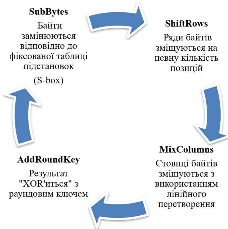
Рис. 1 Схематичне зображення шифрування в AES (Advanced Encryption Standard)
