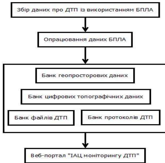
Рис. 3.1. Структурна модель геоінформаційного забезпечення веб-порталу Структуру інтерфейсу доступу до функцій веб-порталу «ІАЦ моніторингу ДТП» подано на рис. 3.2.
