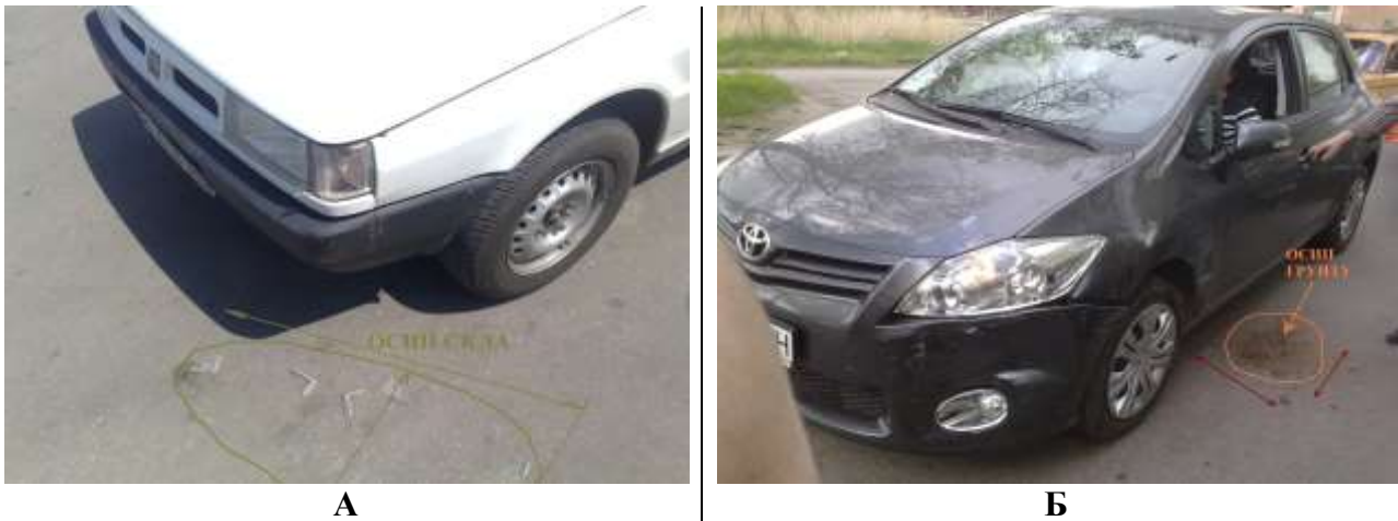
Малюнок 31. Визначення меж осипу скла та ґрунту
