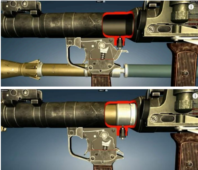
Рис. 47. Положення бойкового механізму та УСМ до заряджання
