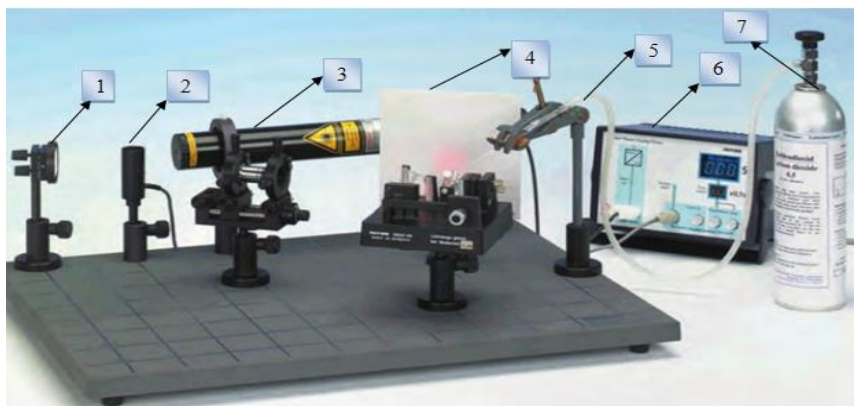
Рисунок 31 Визначення індексу CO_2 при використанні інтерферометра Майкельсона
