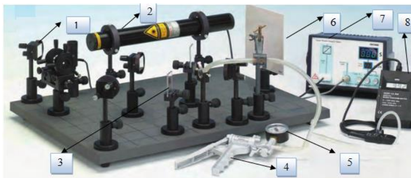
Рисунок 32 Визначення індексу заломлення повітря при використанні інтерферометра Маха-Цендера Технічні характеристики
