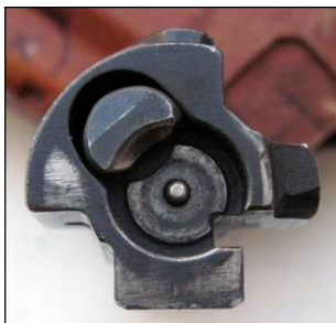
Рис. 17. Чашка затвору 7,62x39 мм мисливського карабіна «АКМС-МФ», виробництва НВО «Форт», м. Вінниця, Україна.
