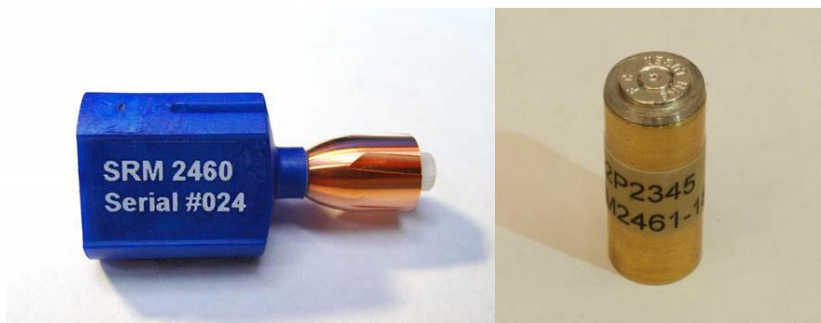
Рис. 2. Стандартна куля NIST SRM 2460, установлена на синій заглушці (ліворуч) та прототип стандартної гільзи SRM 2461 (праворуч) (Національний інститут стандартів і технологій США).
