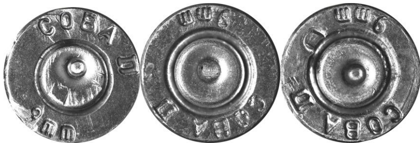
Рис. 18. Зображення криміналістичної мітки на слідосприймальній поверхні гільзи, стріляної з пістолета «ЕРМА-Z85Т» (ліворуч); на слідосприймальній поверхні гільзи, стріляної з пістолета «Беркут – Streamer» (в центрі); на слідосприймальній поверхні гільзи, стріляної з пістолета «ПМР-УОС» (праворуч).
