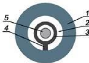
Рис. 2.6. Прицілювання з діоптричним прицілом з кільцевою мушкою: 1 - діоптр; 2 - отвір діоптра; 3 - кільцева мушка; 4 - кронштейн кріплення мушки; 5 - «яблучко» мішені
