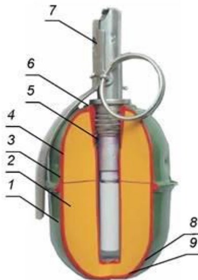
Рис. 2.24. Ручна осколкова граната РГД-5: 1 - корпус; 2 - розривний заряд; 3 - ковпак; 4 - вкладиш ковпака; 5 - трубка для запалу; 6 - манжета; 7 - запал; 8 - піддон; 9 - вкладиш піддона
