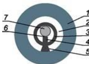
Рис. 2.5. Прицілювання з діоптричним прицілом з прямокутною мушкою: 1 - діоптр; 2 - отвір діоптра; 3 - намушник; 4 - мушка; 5 - основа мушки; 6 - центр; 7 - «яблучко» мішені
