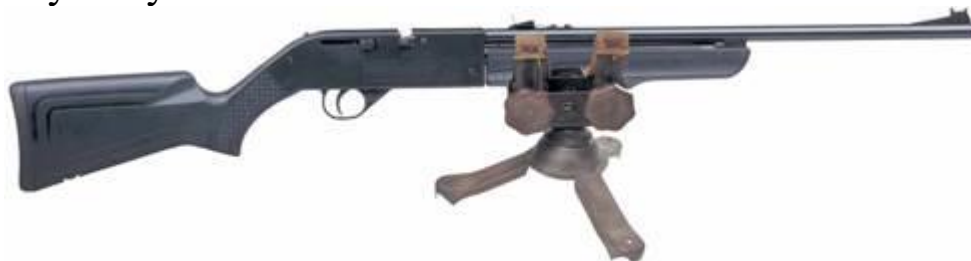
Рис. 2.13. Гвинтівка, закріплена у прицільному верстаті ПС-51
