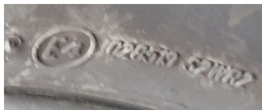
Фото 9.1.15 Знак і номер офіційного затвердження типу шин відповідно до вимог Правил ЕЄК ООН № 54
