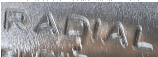
Фото 9.2.12 Позначка типу каркаса шини – Radial (Радіальний)
