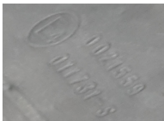
Фото 9.2.22 Знак і номер офіційного затвердження типу шин задньої осі відповідно до вимог Правил ЕЄК ООН № 54
