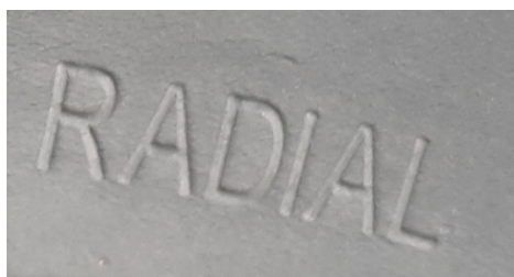
Фото 9.2.20 Познака типу каркаса шини – Radial (Радіальний)
