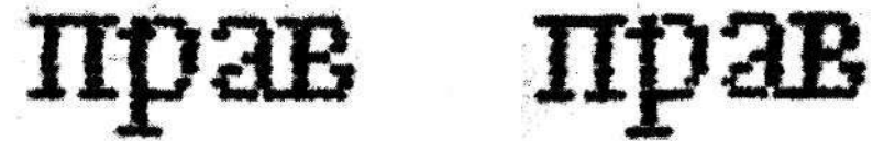
Рис. 3. Фрагменты текстов, выполненные на двух разных 9 – игольчатых принтерах одной модели EPSON LX 1050
