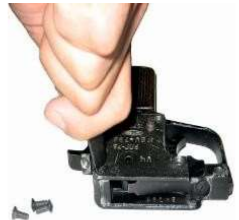
Рис. 46. Відокремлення кришки УСМ
