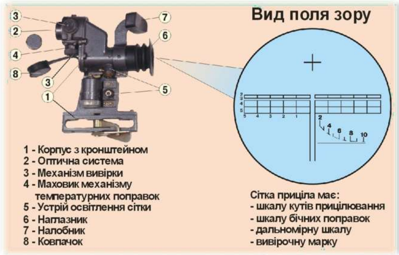
Рис. 33. Устрій прицілу гранатомета
