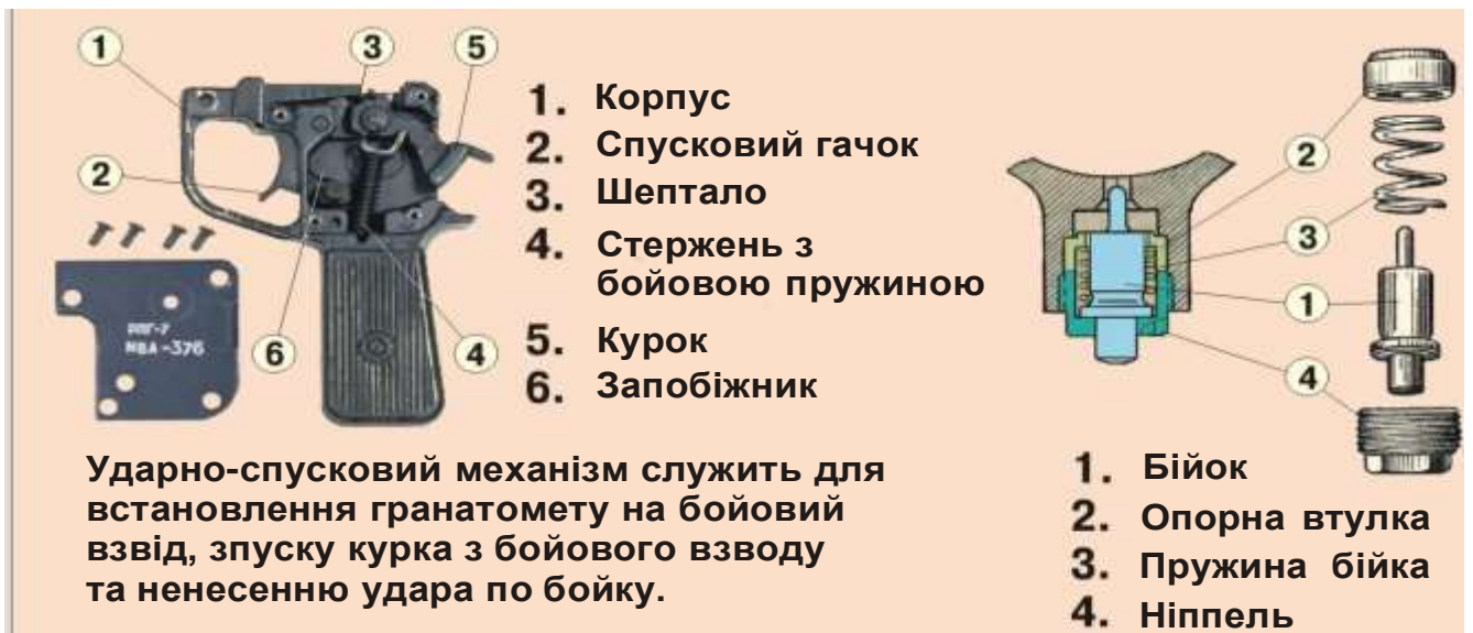
Рис. 10. Ударно-спусковий механізм із запобіжником та бойковий механізм.
