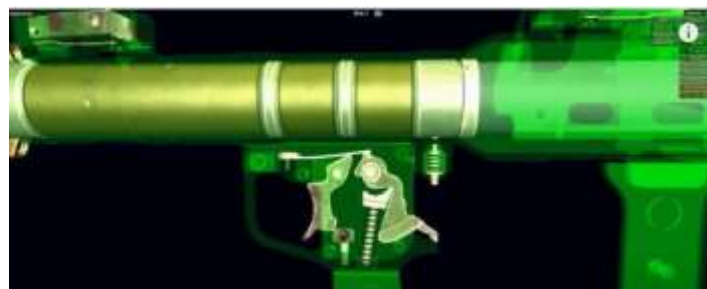
Рис. 49. Положення УСМ перед пострілом
