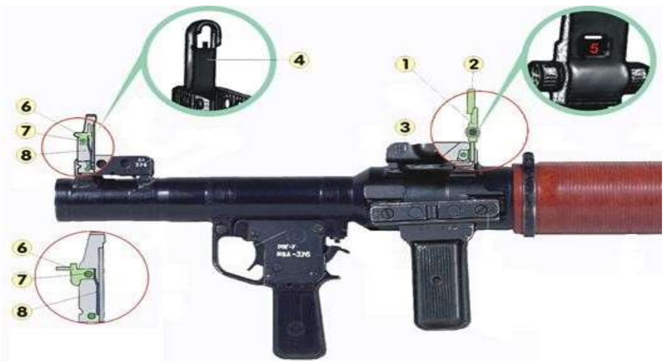
Рис. 8. Механічний приціл гранатомета РПГ-7
