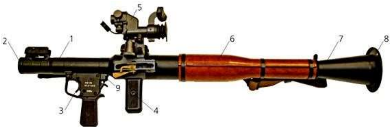
Рис. 7. Основні частини та механізми гранатомета
