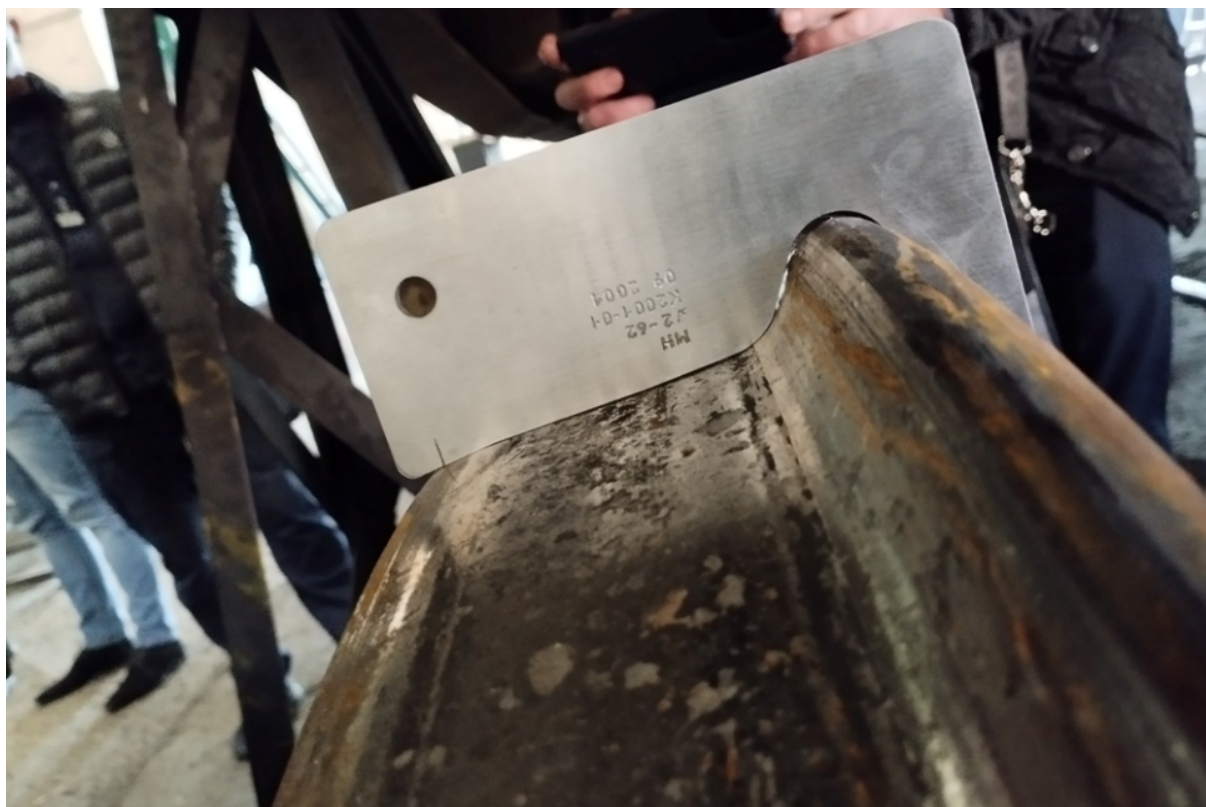
Рис. 3.1. При замірі рівномірного прокату всіх колісних пар встановлено плюсовий прокат по колу кочення, що вказує на не відповідну висоту гребнів колісних пар
