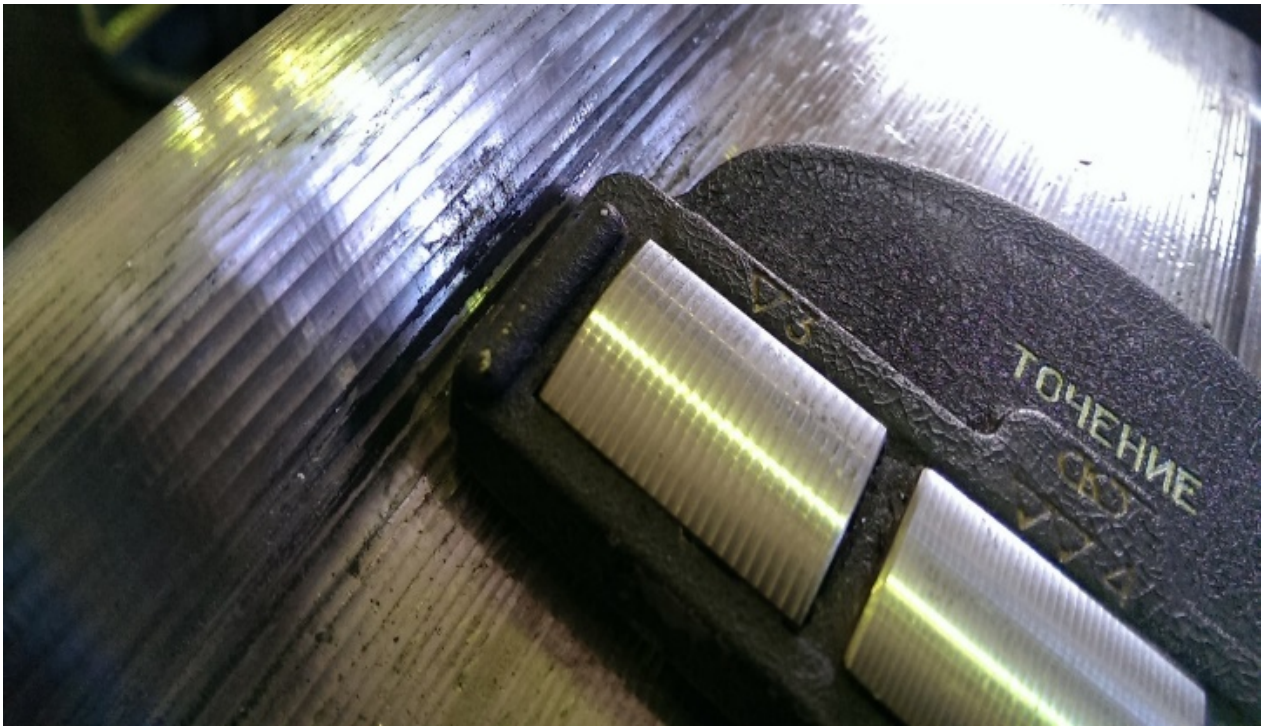
Рис. 37 Шорсткість поверхні кочення та робочій поверхні гребня після обточування не відповідає вимогам нормативних документів
