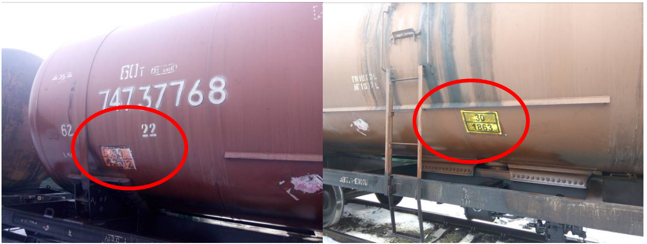
Рис. 64 Приклад нанесення маркування вагона-цистерни в порушення вимог нормативно-правових актів
