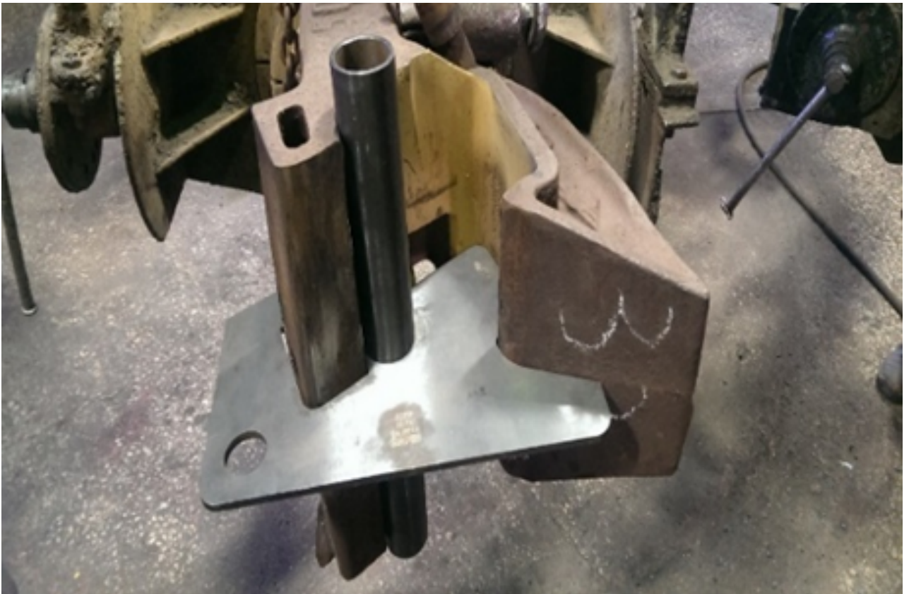
Рис. 41 Контур зачеплення корпусу автозчепу не відповідає прохідному шаблону 827р
