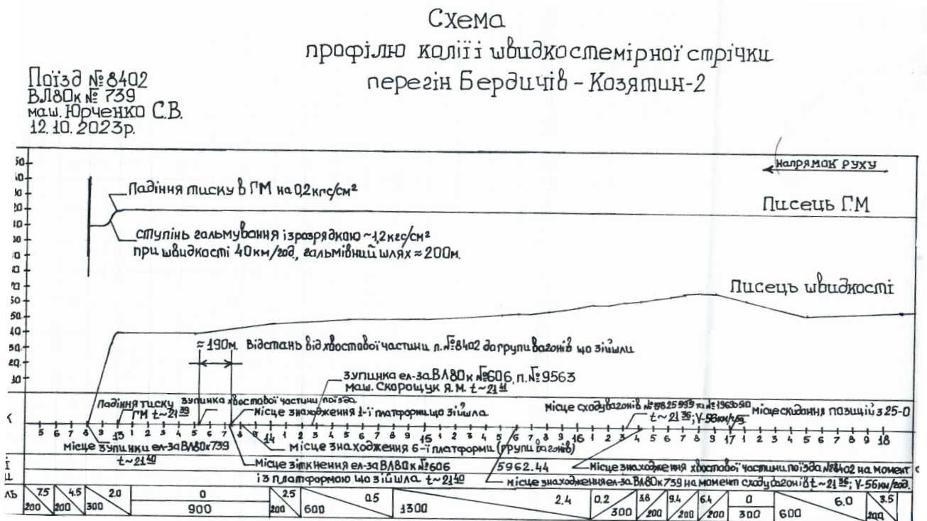
Рис. 2.3. Схема профілю колії зі звіставленням до швидкостемірної стрічки п. № 8402
