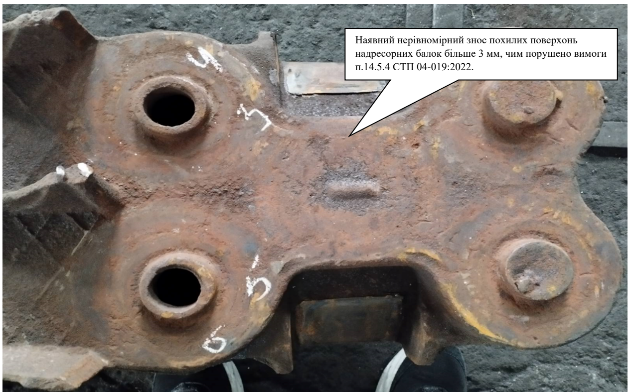
Рис. 3.7. Наявний нерівномірний знос похилих поверхонь надресорних балок більше 3 мм, чим порушено вимоги п.14.5.4 СТП 04-019:2022
