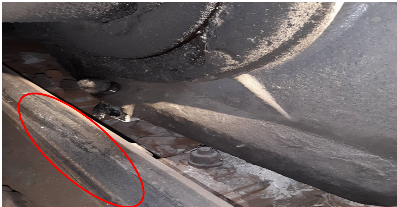
Рис. 61 Слід кочення колісної пари по головці залізничної рейки та пошкодження колісної пари після сходження з залізничних рейок
