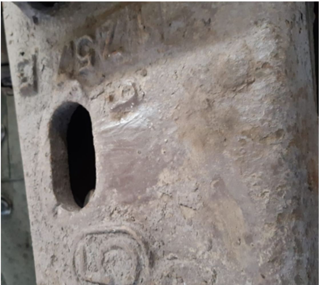
Рис. 3.11. Фото надресорної балки № 517573 вагону № 19825959 з відсутнім тавром року виготовлення
