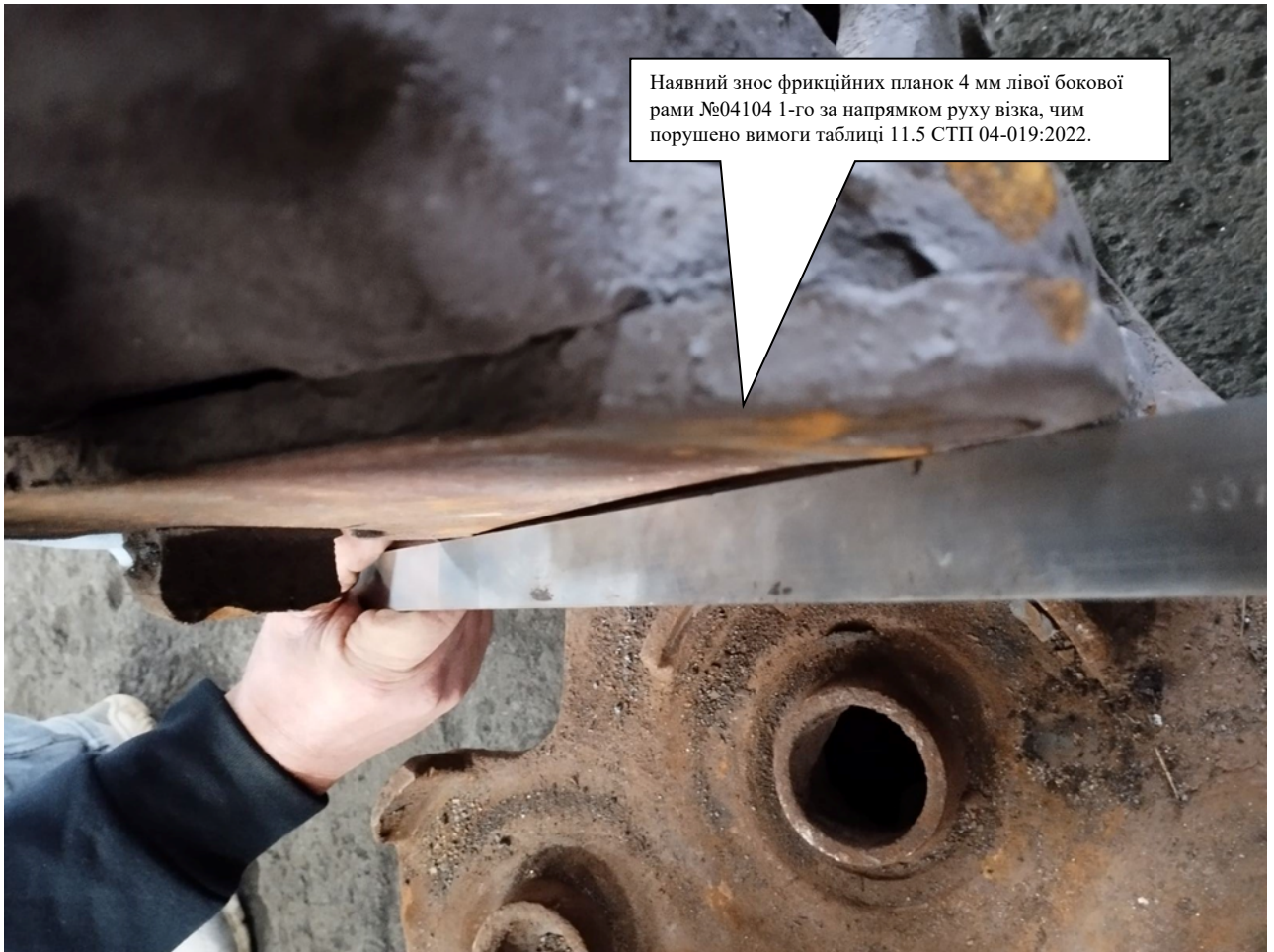
Рис. 3.8. Наявний знос фрикційних планок 4 мм лівої бокової рами №04104 1-го за напрямком руху візка, чим порушено вимоги таблиці 11.5 СТП 04-019:2022.
