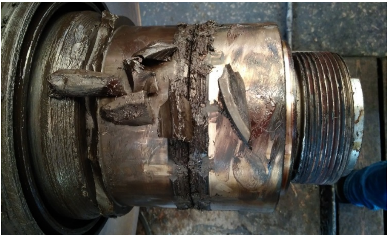
Рис. 34 Злам бурта внутрішнього кільця заднього підшипника
