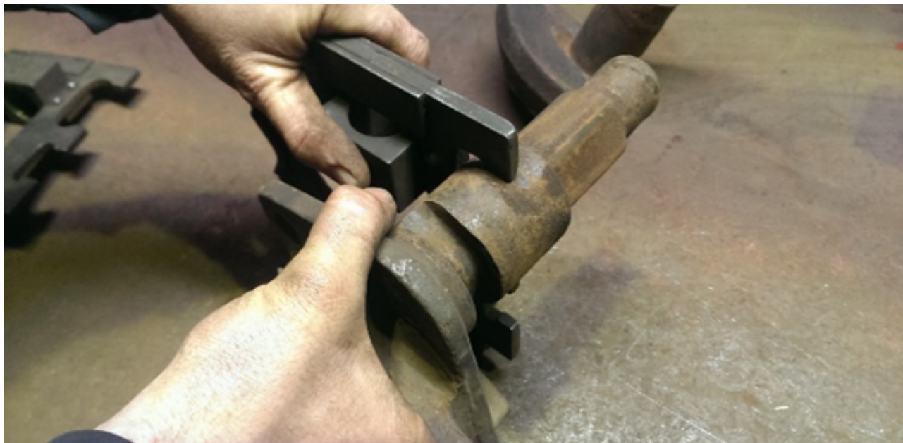
Рис. 39 Стержень валика циліндричною частиною великого діаметра проходить у непрохідний виріз шаблону 919р
