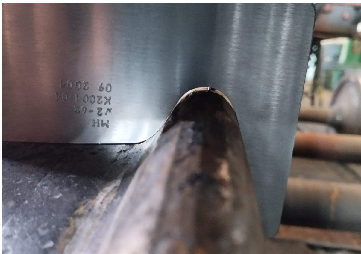
Рис. 3.2. При замірі рівномірного прокату всіх колісних пар встановлено плюсовий прокат по колу кочення, що вказує на не відповідну висоту гребнів колісних пар
