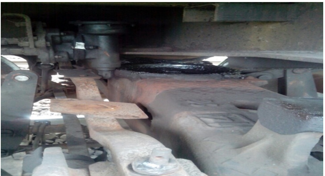
Рис. 38 Порушене регулювання зазорів ковзанів візка вантажного вагона
