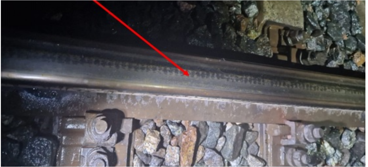
Рис. 3.12. Видимі сліди галопування на головці рейки вагону № 19825959
