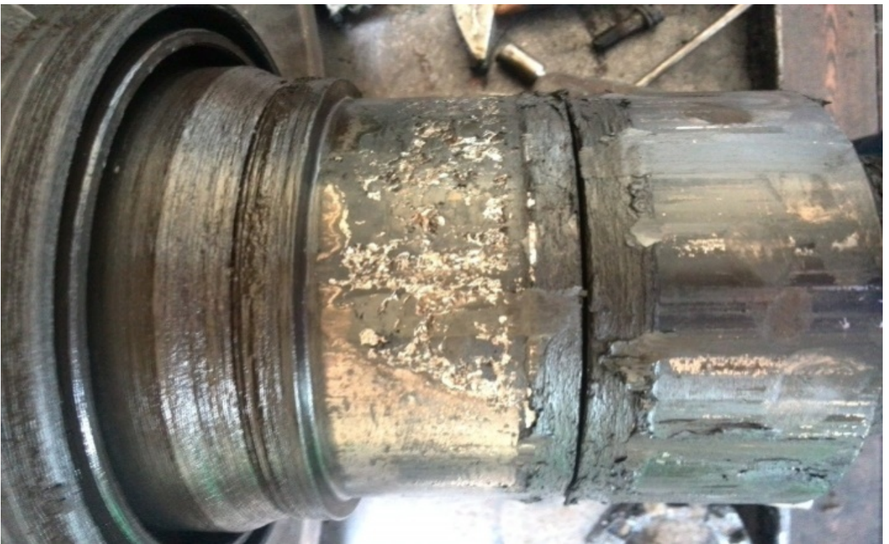
Рис. 36 Провертання внутрішніх кілець переднього та заднього підшипника через порушення технології ремонту
