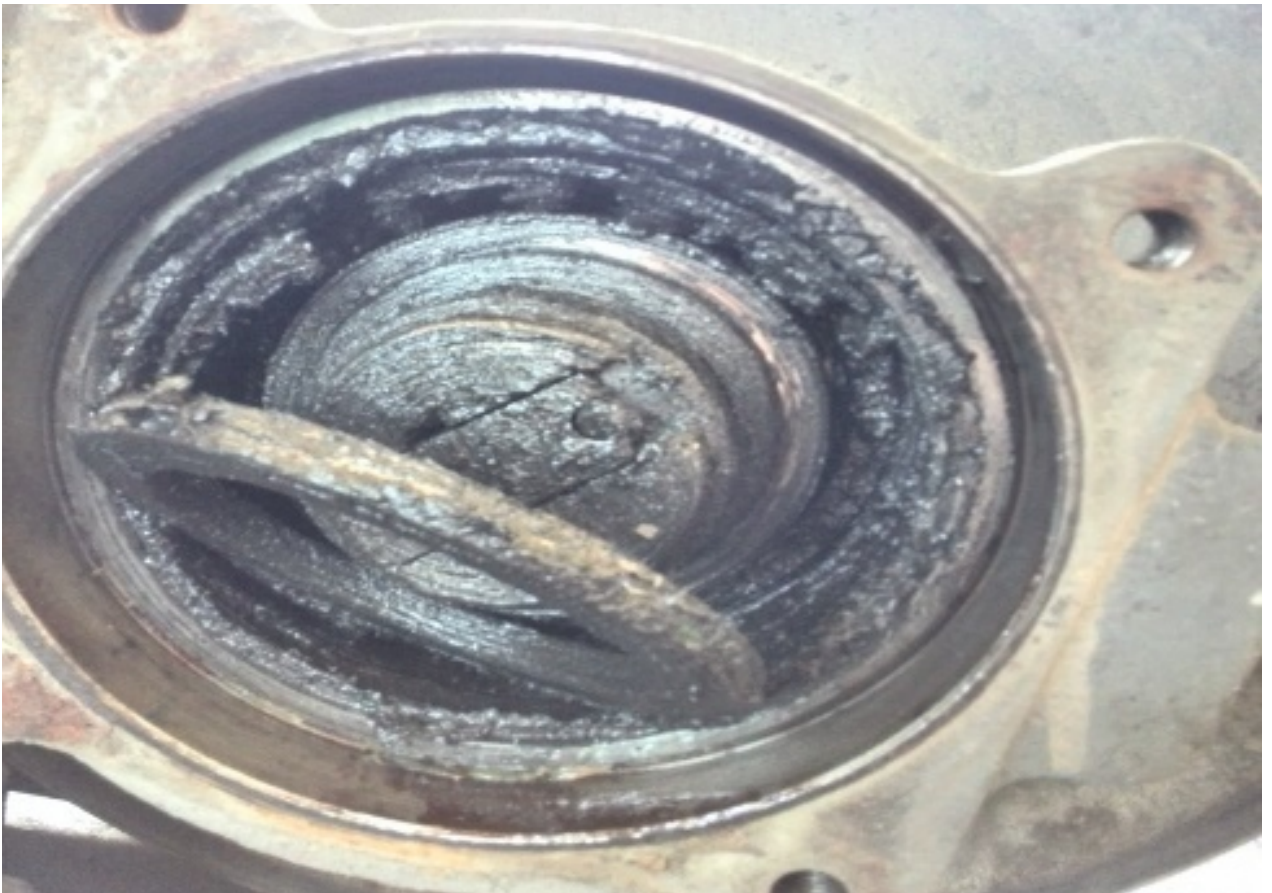
Рис. 35 Порушення торцевого кріплення гайки М110 внаслідок зламу стопорної планки
